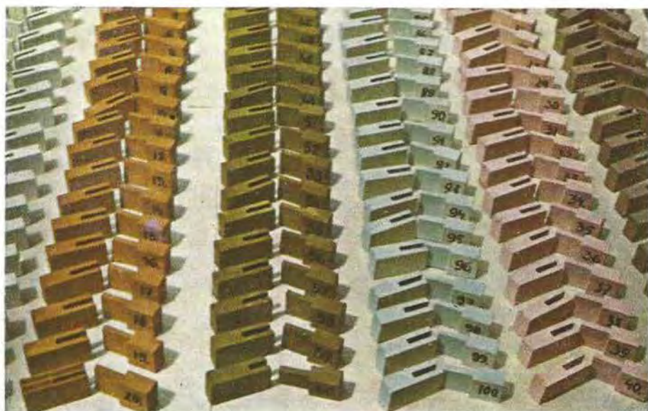
11. ábra. Ecsetelési eljárással történő antiszeptikus kezelésre végzett kísérletek sarkított, ollós csapolású próbatestekkel
