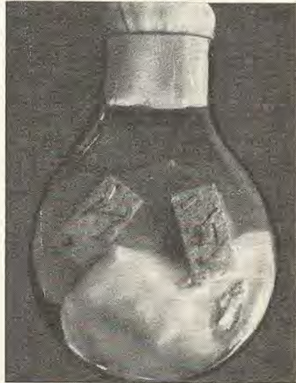
6. ábra. Toxicolor Extra védőhatása Merulius Lacrymans fertőzésével szemben
