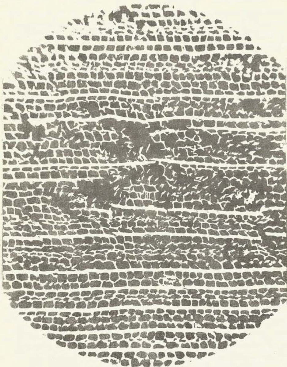
2. ábra Destruktív korhadás mikroszkópos vizsgálata (Mikrofelvétel.)
