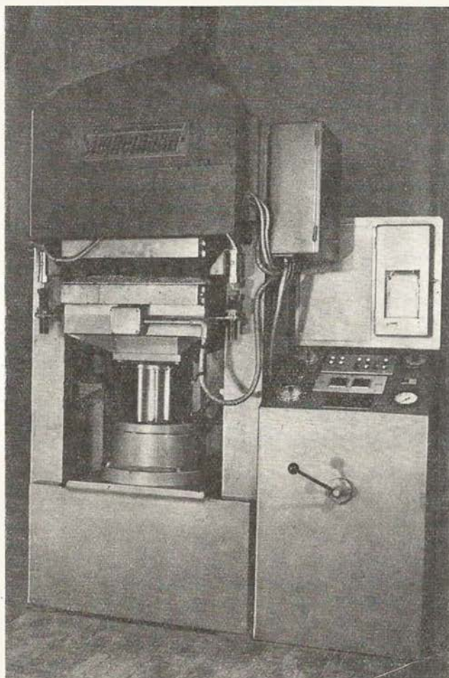
7. ábra. Laboratóriumi hőprés relaxációs berendezéssel és nyomásregisztrálóval felszerelve
