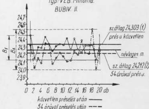
11. ábra. Hidraulikus pré- sen furnérozott alkatrészek méretszórása préselés után közvetlenül és kihűlés után
