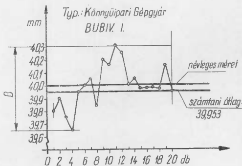
4. ábra. Körfűrészén vágott alkatrészek méretszórásáról készített grafikon
