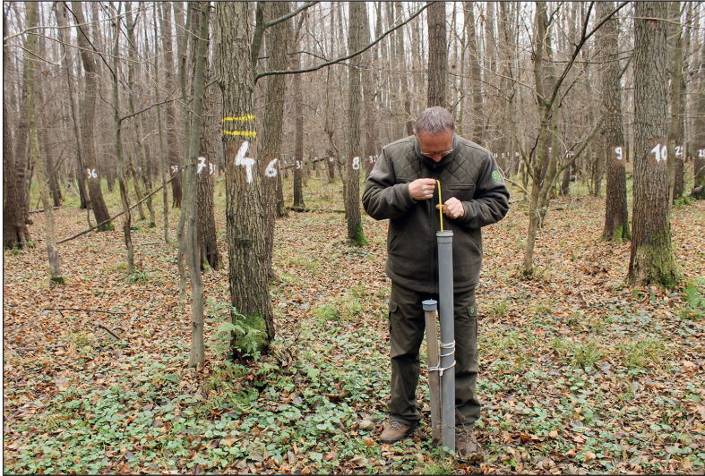
2. ábra: A talajvízszint mérése Figure 2: Measuring the groundwater level
