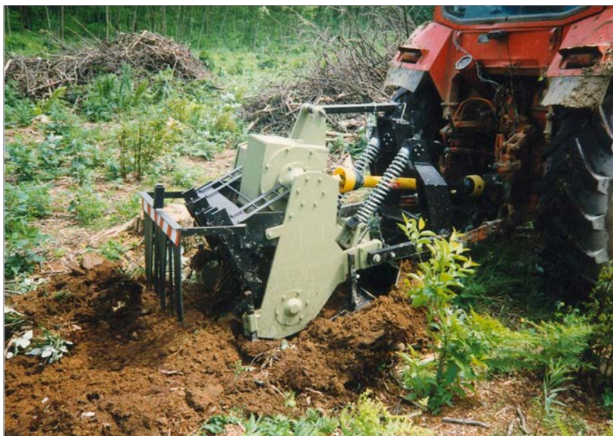
1. ábra: BPG-600 típusú pásztakészítő gép Figure 1: The BPG-600 type soil tiller machine
