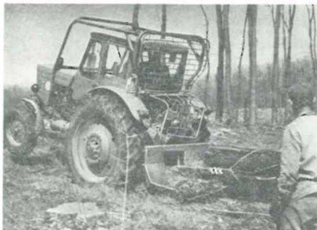
2. ábra. Egydobos csörlővel felszerelt MTZ—50 traktor (Felső-tiszai EFAG) Рис. 2. Трактор МТЗ—50 с лебедкой ТНП
