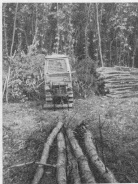
3. ábra. Cs—S—W 1972, ERTI csörlő bolgár kistraktorra szerelve, kiközelítést végez
