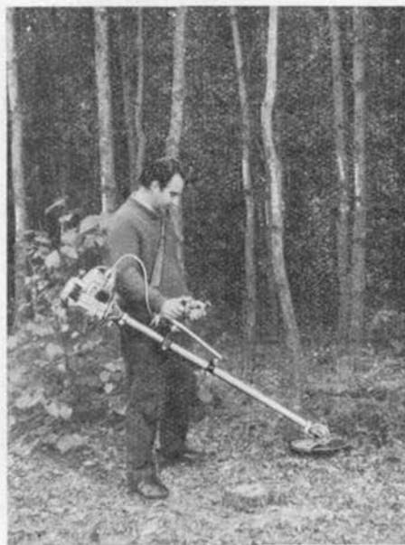
2. ábra. Stihl motorra szerelt tisztító körfűrész munka közben
