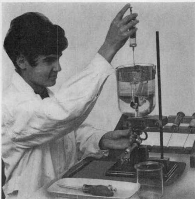
Abbildung 3. Zur Bestimmung des \text{CO}_2 - und \text{O}_2 -Gehaltes des Luftmusters dient ein Scholander-Apparat (Photo: Michalovszky)
