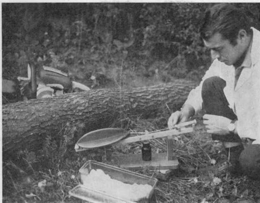
Abbildung 2. Das für eine laboratorische Analyse vorgesehene Luftmuster wird in einer Pravaz-Spritze aufbewahrt (Photo: Michalovszky)
