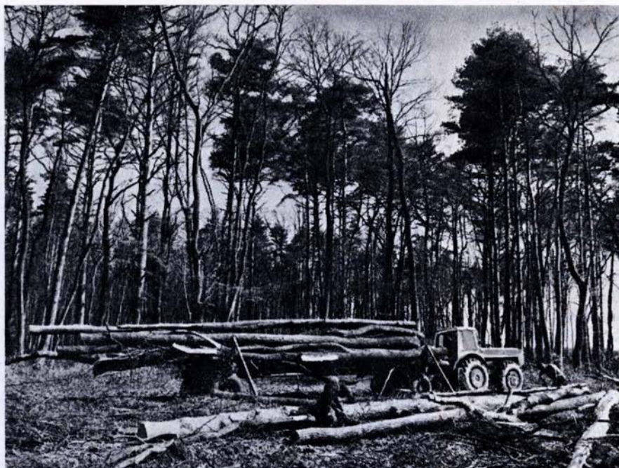
3. ábra. A D4-K traktor a 2 dobos csörlő segítségével a hosszúfát a Horanét pótkocsira terheli
