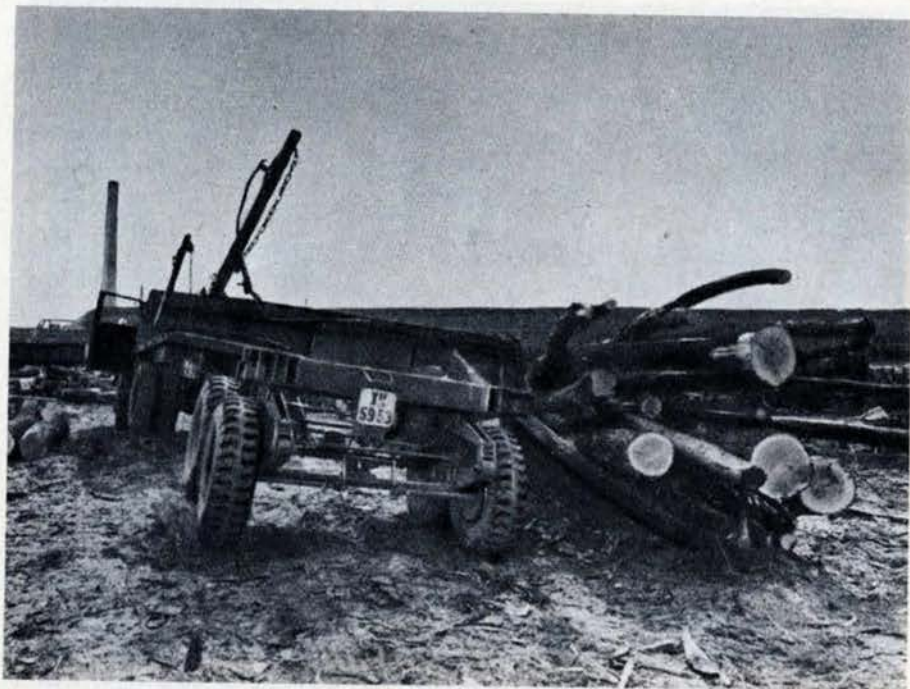
7. ábra. A két papucson álló Csepel D-344 az orrcsörlő és a kitelepített terelőcsigák segítségével a teljes terhet lehúzza önmagáról
