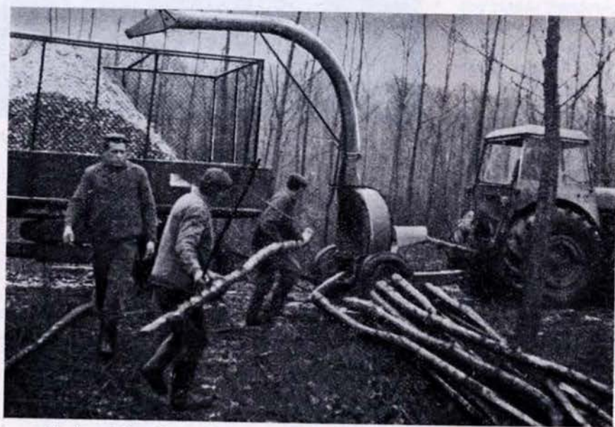
10. ábra. Kiközéltett nemes nyár anyag aprítása a Kölked 87/d erdőrezsletben (Fotó: dr. Balogh)
