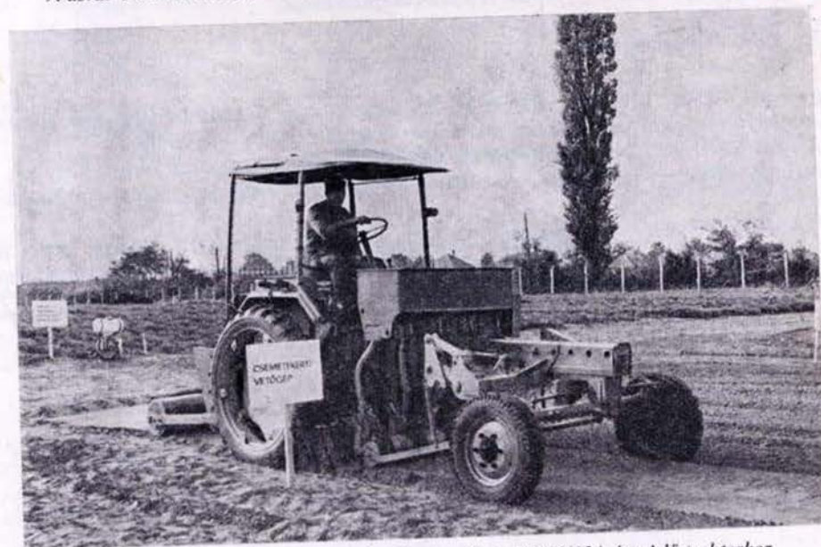
8. ábra. ERTI univerzális csemetekerti magvetőgép RS-09/124 típusjelű traktorhoz
