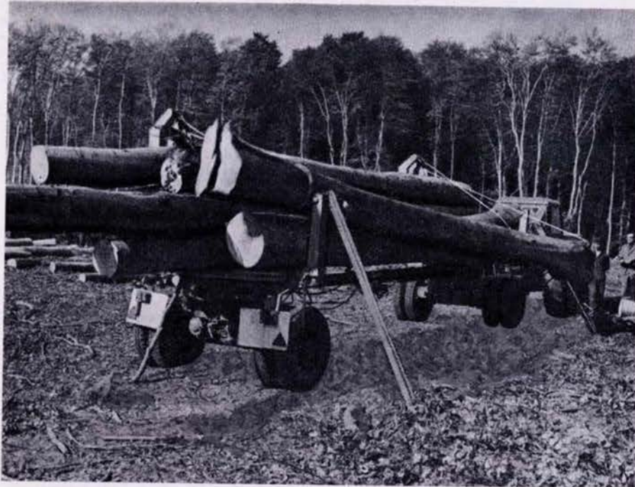
9. ábra. A Keszthelyi hosszúfás pótkocsi csörlős traktorral
