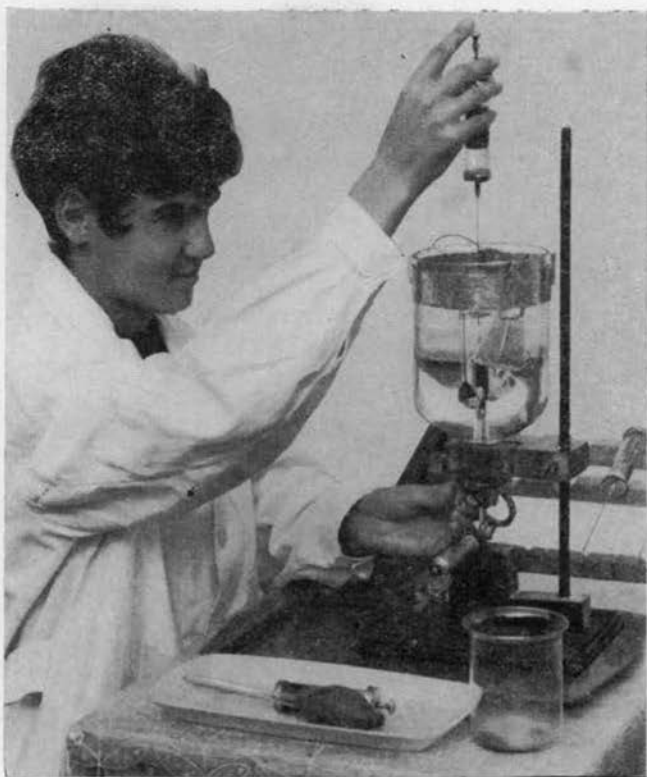
3. ábra. A légminta CO_2 és O_2 tartalmának a meghatározására Scholander-készülék szolgál (Fotó: Michalovszky)
