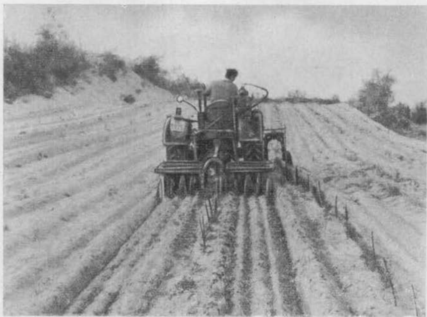
3. ábra. ERTI-sorápológép és négyrelekes Marton-féle tárcsa a sor és sorköz egyidejű művelése közben
