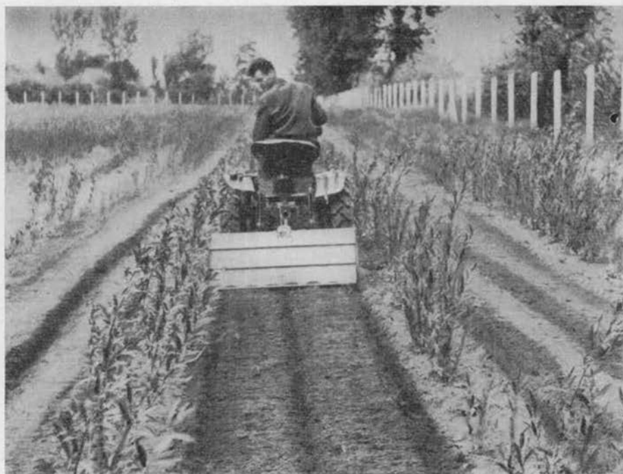
2. ábra. A T4K-12 kistraktor FN-100 forgókapával
