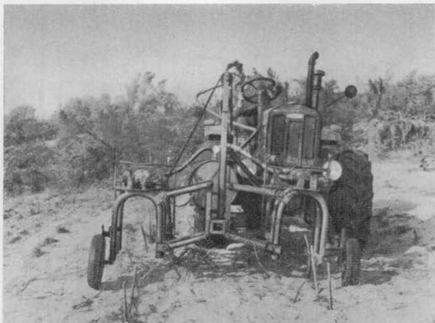
2. ábra. ERTI-sorápológép első éves fekete fenyő sorművelése közben
