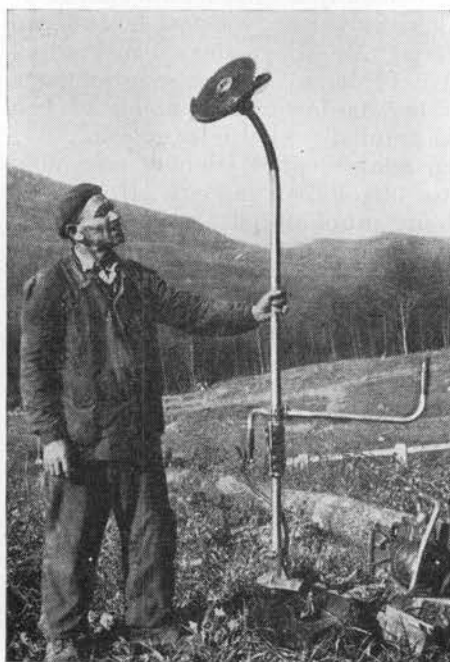
1. ábra. Homelite 7—19 típusú benzinmotoros láncfűrész döntésre alkalmas vezető-lemezzel
