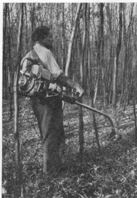
3. ábra. A motor és körfűrész helyzete munka közben
