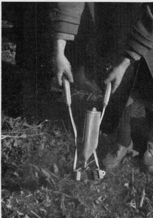
68. ábra. Vadkár elleni védőanyag felkenésére szolgáló tartályos kefeberendezés
