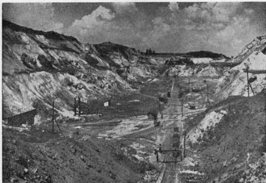
20. ábra. A rudabányai barnavasérc bánya félvszázados külszíni fejtését a vékony letakarító szeletek sok apró szintre tagolják
