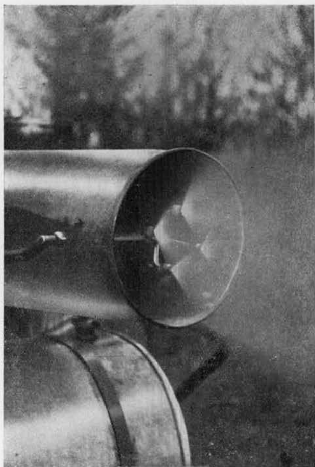
22. ábra. A „Swissatom 2000” permetező-porozó gép ventilátorának fúvócsöve (Foto ERTI)
