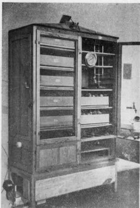
38. ábra. Kísérleti magpergető-szekrény az ERTI magvizsgáló laboratóriumában.
